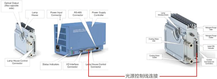
注意: EQ光源充氮气用来保护EQ光源室中的光学元件, 耦合光路充氮气用来保护耦合光路中的光学元件。
