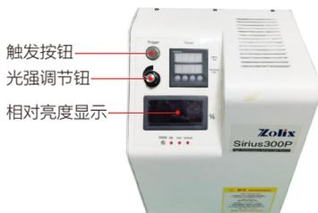
TLS2/3-X300P/X300PU操作面板
