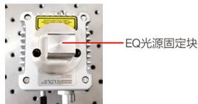
第二步，将EQ光源，按照如下图所示的方向安装到耦合光路的光源固定座上，然后用锁紧旋钮把EQ光源锁紧固定。
