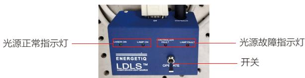
注意：如果有任意一个红灯亮，首先断电，然后检查接线是否正确，正确接线后再重复第1~3步骤开灯，如果确信接线无误但仍然无法点亮，请联系售后服务人员返厂维修。
