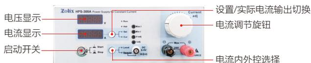
TLS2/3-X150A /TLS2/3-T150A/TLS2/3-T250A系列电源前面板
