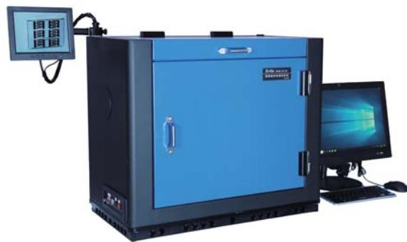
SCS600 是卓立汉光自主研发的高性能太阳能电池量子效率 / 光谱响应测试系统的第二代产品，适用于测量各种材料的太阳能电池，适合高校、研究所和企业的研发与生产品质管理使用。相比第一代产品，软件设计更加人性化，操作简单，并且新增高精度吉时利 2612B、2636B 的数字源表，提升了数据采集能力和偏压测试能力，样品室空间更大，采用顶门、前门双门设计，摆放、更换样品更容易。此外，卓立汉光提供定制服务，根据客户需求，定制化硬件配置和软件开发，使设备发挥一机多用的最大效能。
